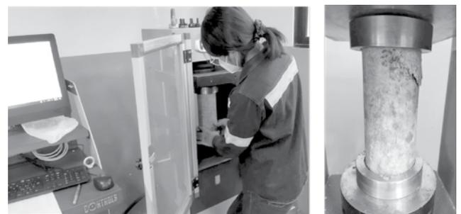
Figura 8. Ensayo a compresión en cilindros de hormigón laterítico.
