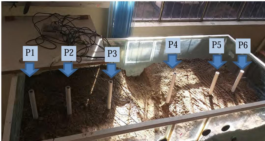
Figura 2. Fotografía del modelo experimental construido en el Laboratorio de Hidráulica de la UMSS. Consta de un receptáculo de vidrio, el material granular de la zona de estudio, los piezómetros instalados (P1 a P6) y la instrumentación para medir niveles de agua y humedad del suelo a distintas profundidades.
