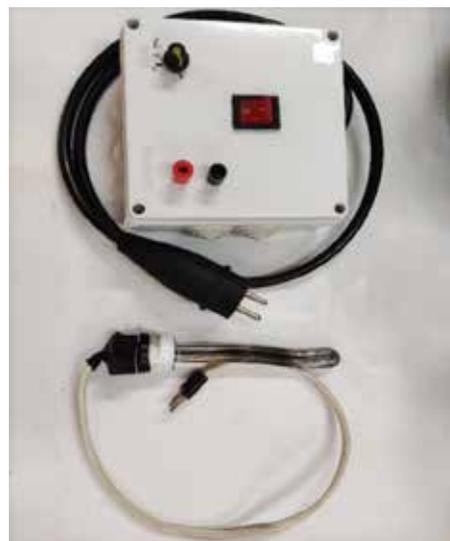
Figura 1. Equipo micro-Kjeldahl para determinar proteína en quinua. A) Destilador micro-Kjeldahl B) Resistencia eléctrica y controlador de potencia
