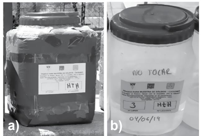
Figura 2. Recipientes de politeileno utilizados en prueba de estabilidad. a) Cubiertos con material opaco, b) Translucidos.
